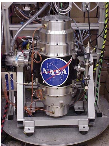
G2 Flywheel modul i zamašnjak http://spacepower.grc.nasa.gov/ radi pri frekvenciji od 30000 okr/min. Modul odlikuje dugo vrijeme života 10^5 - 10^7 ciklusa punjenja-pražnjenja, visoka gustoća energije 0.5 MJ/kg, te velika izlazna snaga 3 - 133 kWh, i efikasnost od 90%.
