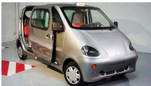
CityCat - automobil na komprimirani zrak čija se serijska proizvodnja očekuje u kolovozu 2008.
