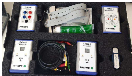
SLIKA 1. Set opreme TESS Cobra4 Electrophysiology. Pomoću ovog seta uče se osnovne metode proučavanja elektrofizioloških procesa u ljudskom tijelu.
