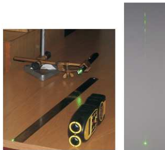
SLIKA 6. Sredstva korišćena u eksperimentu određivanja talasnih dužina svetlosti i difrakciona slika zelene svetlosti.
