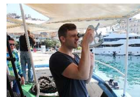
SLIKA 2. Učenik pomoću sekstanta mjeri visinu nebeskog tijela
