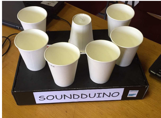
SLIKA 4. Jednostavan uređaj baziran na Arduino platformi koji pretvara vrijednosti razine svjetlosti u zvučne signale omogućavajući tako izvođenje različitih skladbi pokretima ruke.
