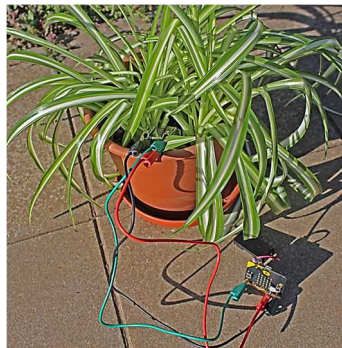
SLIKA 2. Micro:bit korišten za mjerenje vlažnosti zemlje – jednostavan pokus koji učenici mogu samostalno izvesti kod kuće testirajući znanja iz fizike o električnoj provodljivosti, izolatorima te elektrolitima. (slika preuzeta s http://sciencescope.uk/product/microbit-soil-moisture-sensor [4]).
