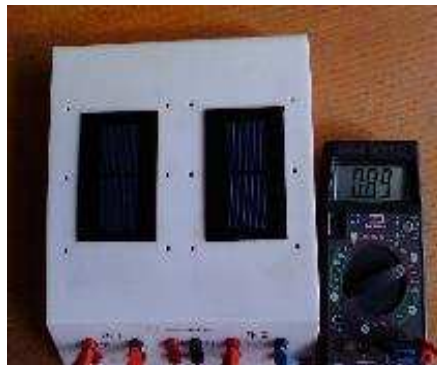
SLIKA 7. Mjerenje napona praznog hoda za serijski spojene solarne ćelije, uz sunčevo svjetlo.
