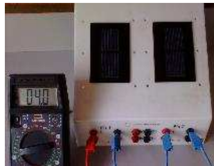
SLIKA 5. Mjerenje struje kratkog spoja za serijski spojene solarne ćelije, bez rasvjete.
