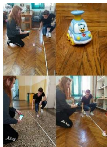
SLIKA 1. Učenici mjere prijedeni put i vrijeme gibanja na različitim podlogama
