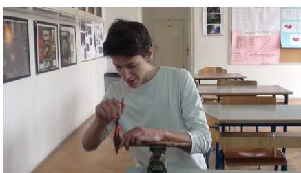
SLIKA 3. Bakrene cijevi ksilofona najbolje je rezati dijamentnim rezačem za bakrene cijevi
