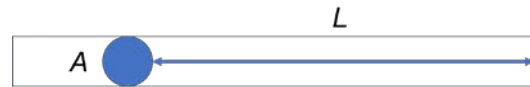
SLIKA 1. Shematski prikaz puhalice. U cijev se umetne projektil poprečnog presjeka A , tako da do izlaska iz cijevi mora proći udaljenost L .
