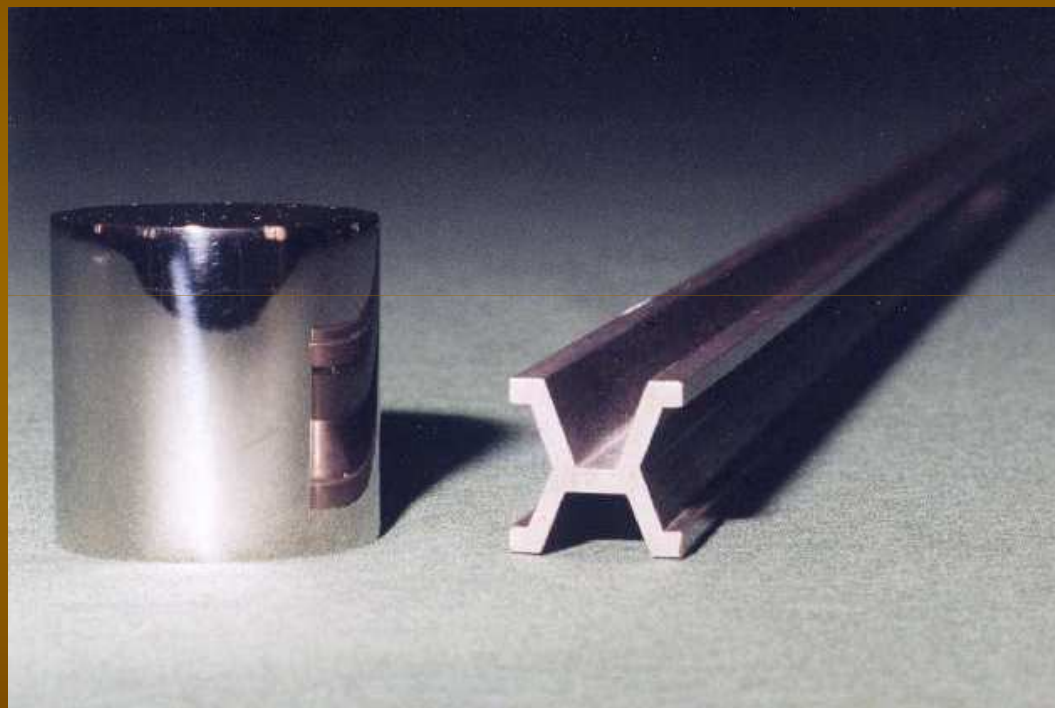
Prototip (prauzorak, pramjera, etalon) kilograma (1889.) i metra (1870.)
